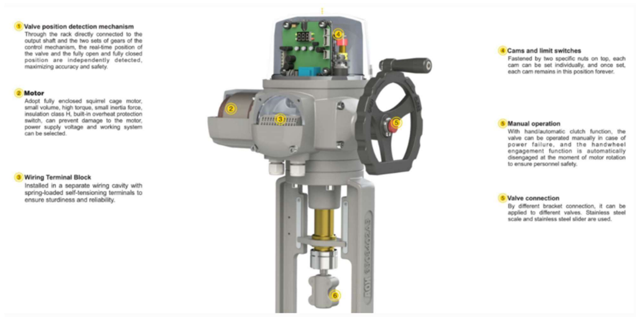
Ilustración 3: Componentes de un actuador
